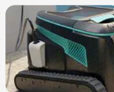
Conductive Charger: Schnelleres Laden als bei induktiver Variante
